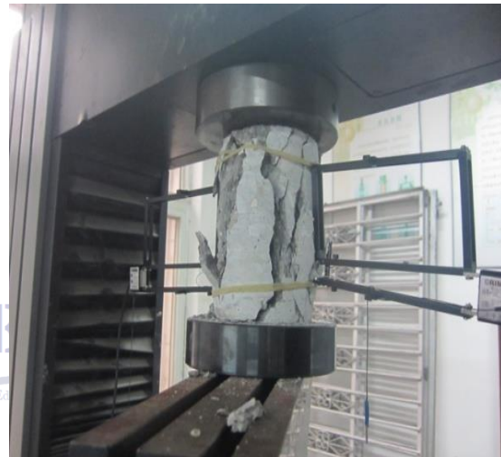
Fig. 10 - OLD1 Specimens failure
